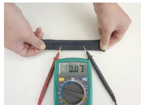
図 2 b 伸ばしたときの CNT ゴムシートの導電性
