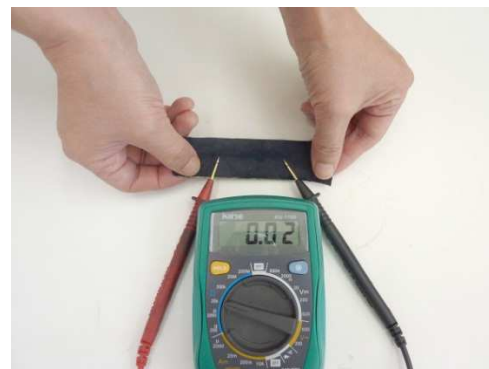
図 2 a 伸ばす前の CNT ゴムシートの導電性
